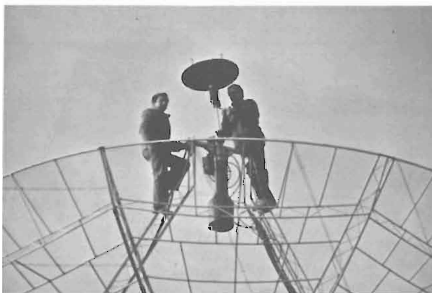
Fig. 5 - i2TFI ed iw2ATM sulla destra all'opera di manutenzione entro il «padellone». Alle loro spalle: il sistema eccitatore con l'illuminatore della gamma 1,3 GHz in posizione; mentre l'antenna dei 432 MHz rovesciata verso l'alto è in posizione «non operativa».
